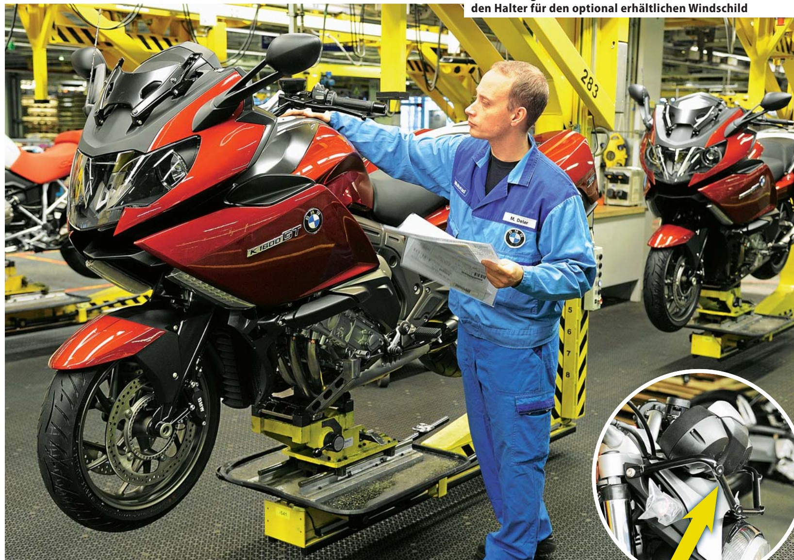
8 Wenn die Motorräder die technische Prüfung bestanden haben, werden sie auf vier Endmontagebändern komplettiert. Die K 1600 erhalten hier ihre voluminösen Verkleidungen und Koffer, die R 1200 R im kleinen Bild den Halter für den optional erhältlichen Windschild
