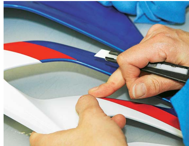
7 Die rechte Verkleidungsflanke einer S 1000 RR im Rennsport-Farbmuster. Von Hand werden die roten Farbflächen aufgeklebt, dann folgt eine Schicht Klarlack
