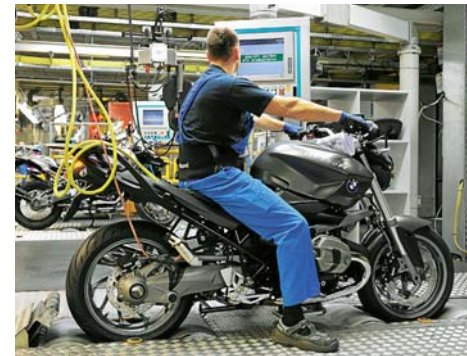
9 Beim Probelauf werden die technischen Features eines jeden Motorrads erfasst und überprüft. Allein beim ABS betrifft dies über 100 Parameter
