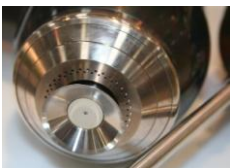
Beim elektrostatischen Lackierverfahren kommen Hochrotationsglocken zum Einsatz, die das Lackmaterial gleichmäßig zerstäuben.
